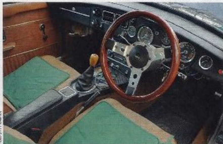
Ve sportovním voze je těsná a vzadu si sednou jen děti. Přakvapením může být záplava informačních budíků včetně ampérmetru nabíjení.
