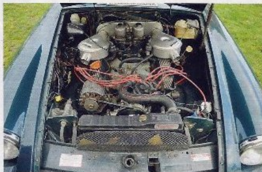
Vidlicový osmiválec se vsází pod kapotu i bez nutnosti jejího vyboulení. Je ale posazený až na karosarii.
